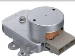
Motoriduttore sincrono ad alte prestazioni formato da un corpo motore separato a due velocità di rotazione di 1.000 giri e 750 giri. Costituito da scatola Riduttore estremamente compatta e resistente, studiata per l'alloggiamento di vari treni di ingranaggi sia plasticci sia metallici.
